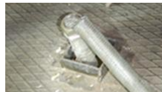
Poškozené vývodky a Weidmueller hadice.
